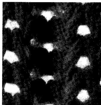
نسيج الحباكة تتمثل في خيط واحد أو مجموعة خيوط تصنع العراوي في الخيط وتشبك معاً مكونة القماش.
