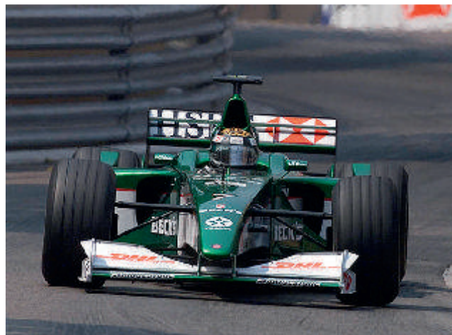
Figure 4.68 F1 cars use negative camber
